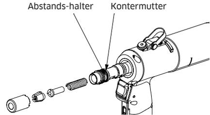
und schrauben Sie das Klemmbackengehäuse ab.
