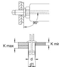
Senkrechte Positionierung des Werkzeugs auf der Oberfläche
